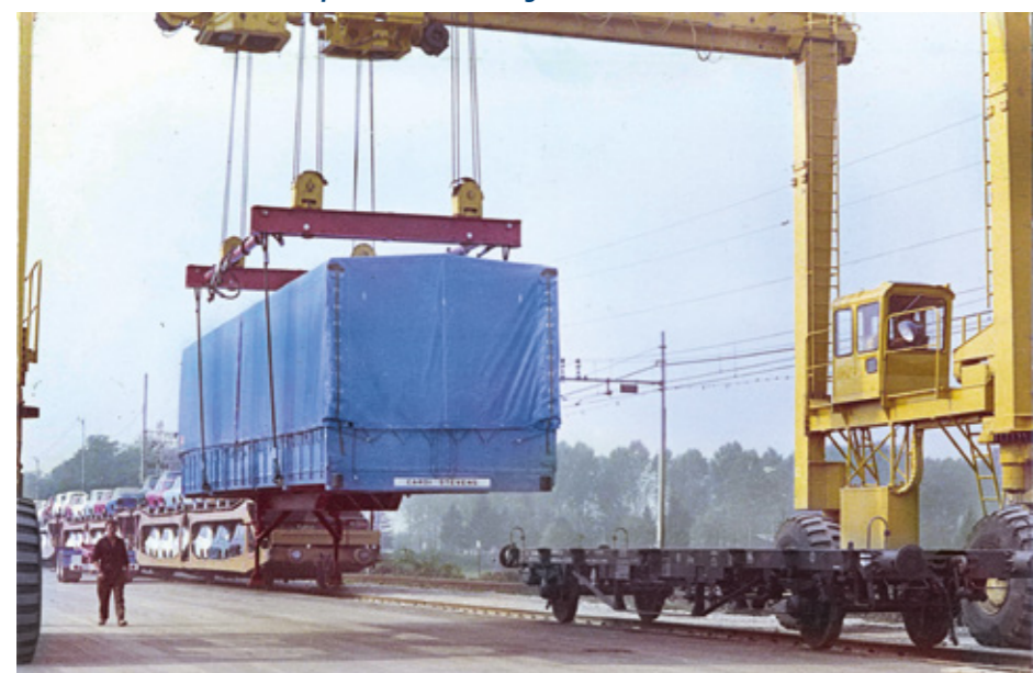
Nei primi anni di attività, scarico di una cassa mobile da un carro pianale a due assi, nel terminal di Candiolo; sullo sfondo i carri per trasporto di automobili nuove, che costituivano un altro importante flusso di traffico dell'impianto (foto Ambrogio).
